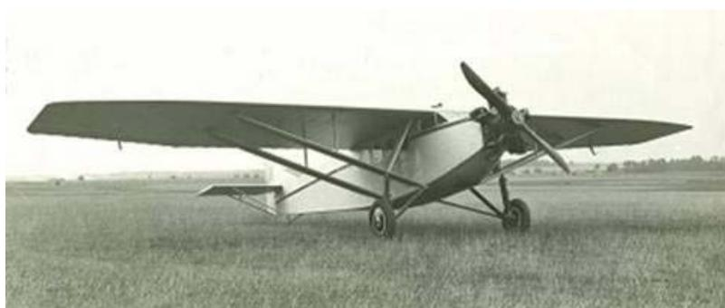
. Caractéristiques F-190 : envergure 14,10 m, longueur 9 m, hauteur 3 m, surface alaire 40 m<sup>2</sup>, masse à vide 1030 kg, masse maxi 1800 kg. Performances : vitesse maxi 180 km/h, vitesse de croisière 160 km/h, distance franchissable 800 km, plafond 5 000 m.
