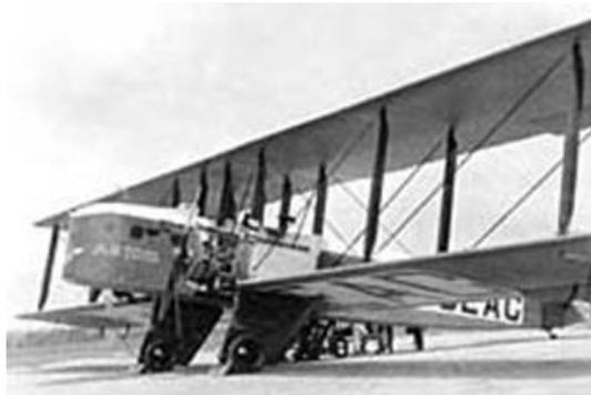
A l'origine, les moteurs, des Salmson Z9, étaient du type en étoile, à refroidissement par eau. Par la suite, divers autres moteurs furent installés ; citons les Salmson 260 de 260 et 300 ch., les Gnome-Renault de 300 et 380 ch., les Lorraine-Dietrich ... et Rhône-Jupiter.
