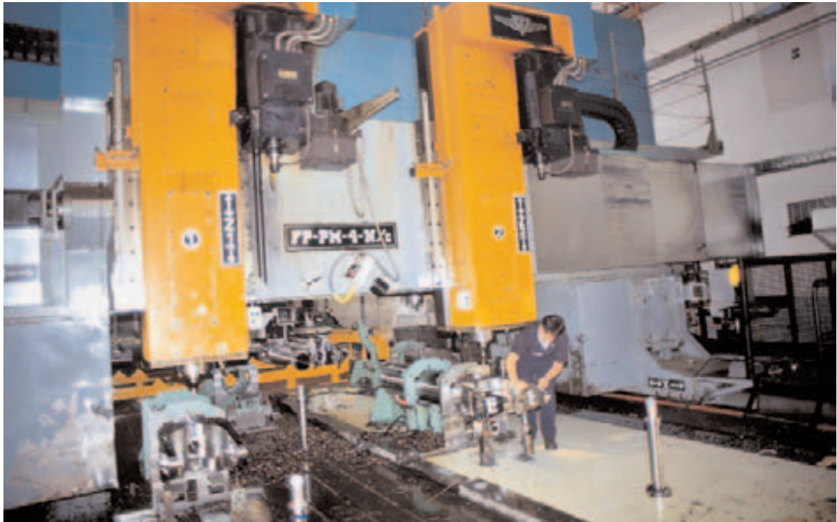
3-26 : Fraiseuse multibroches à portique mobile de l'usine de Bidos (source Messier-Dowty)
