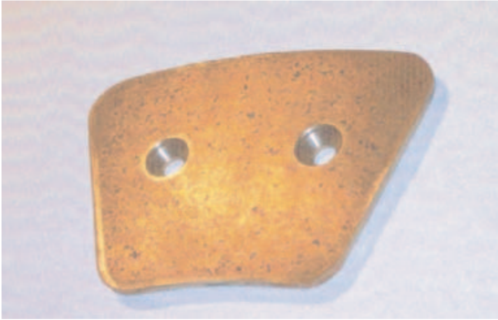
4-6 : Coupelle de frein Messier-Bugatti en matériau fritté pour A310 et A300-600 (source Messier-Bugatti)
