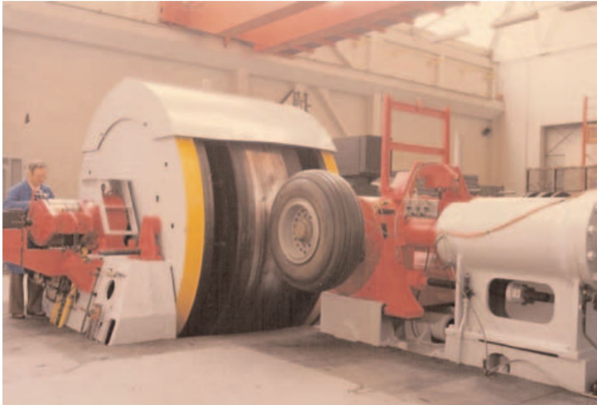
4-27 : La machine Adamson à inertie variable du CEAT (source DGA/CEAT)
