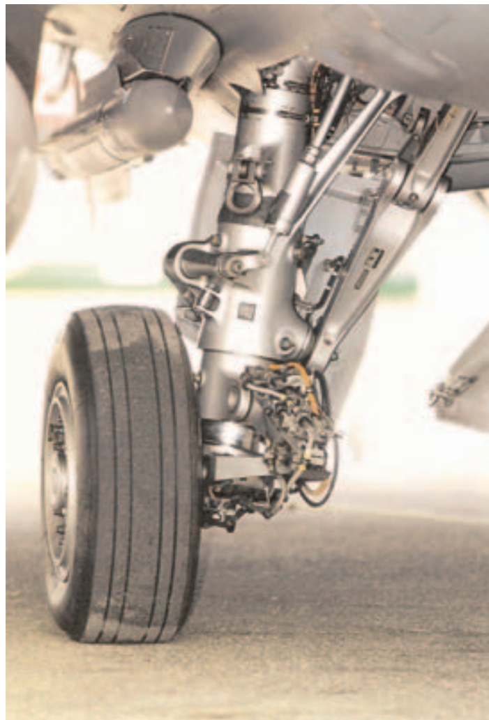
3-9 : Atterrisseur principal à pivotement de roue au relevage du Rafale (source Messier-Dowty)
