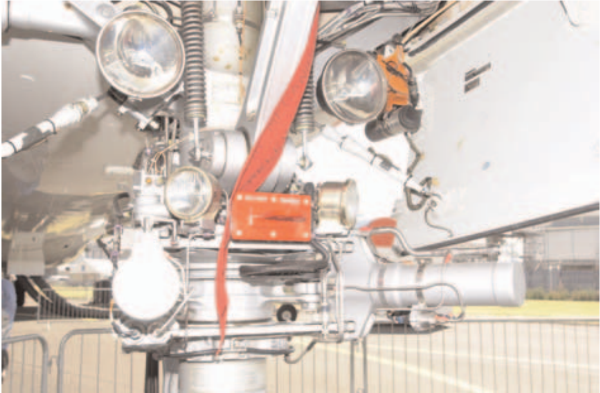
6-1 : Vérins d'orientation de roues de l'A340 (source Messier-Bugatti)
