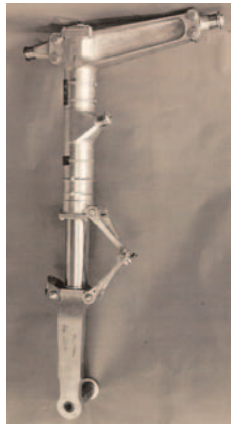
3-6 : Les premières pièces en acier à très haute résistance, sur l'atterrisseur principal du Gerfaut (source Messier-Dowty)
