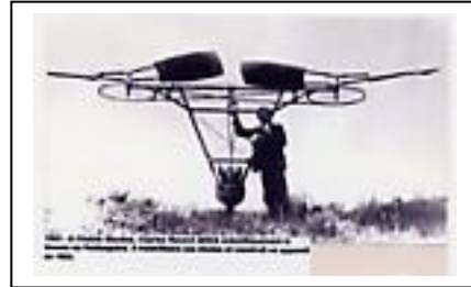
1903 – A Chalais Meudon, Charles Renard définit scientifiquement la théorie de l'hélicoptère. Il matérialisera ses études et construit un appareil en 1904
