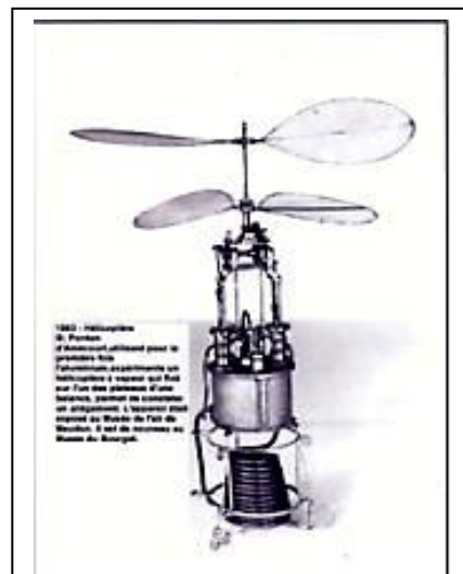
1863-Hélicoptère de Ponton d'Amécourt, utilisant pour la première fois l'aluminium, expérimente un hélicoptère à vapeur qui fixé sur l'un des plateaux d'une balance, permet de constater un allègement. L'appareil était exposé au Musée de l'air de Meudon. Il est au Bourget
