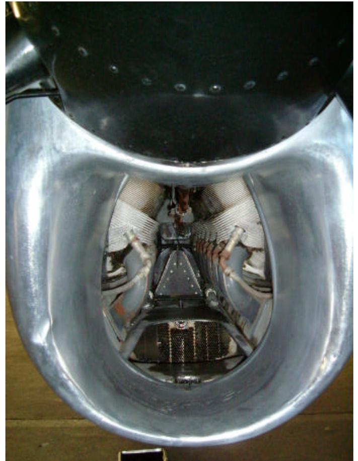
Moteur SNECMA-Renault 12 S de 580 ch du Dassault MD-310-315 Flamant. 320 exemplaires du Flamant ont été fabriqués de 1949 à 1953 et 3 000 moteurs SNECMA-Renault 12 S et 12 T pour l'armée de l'Air et la Marine nationale. (CAEA 2003).
