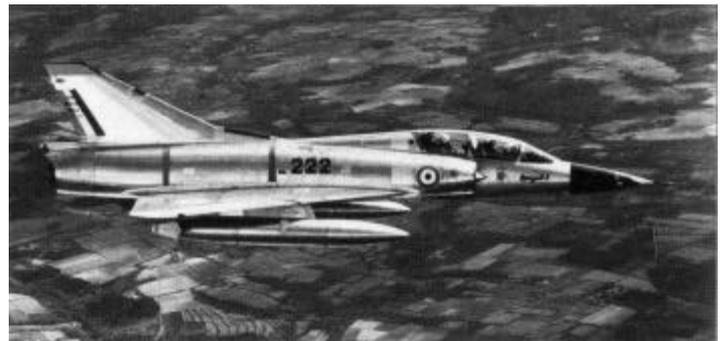
Appareil d'entraînement « Mirage » III B à réacteur ATAR 9B3 de 6000 kgp.
