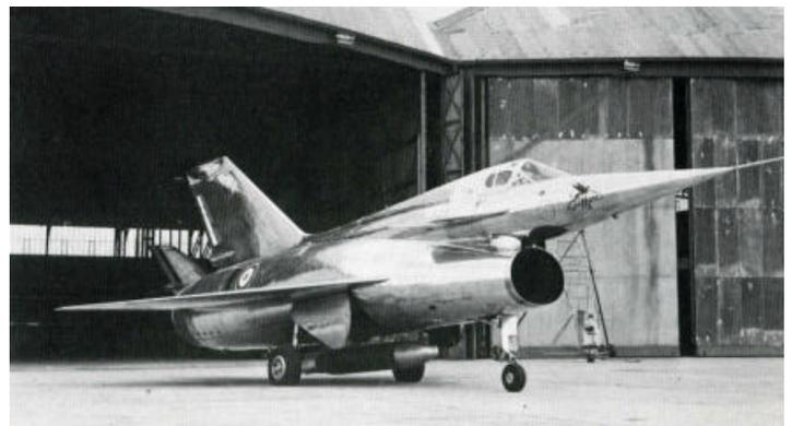
Le 20 septembre 1955, André Turcat fait voler pour la 1<sup>ère</sup> fois le SNCAN Nord-1500 «Griffon » 01 propulsé par un réacteur ATAR 101 F développant 3 800 kgp avec post-combustion. Le 23 janvier 1957, le « Griffon » 02 avec un réacteur ATAR 101 E3 à sortie fixe de 3 500 kgp avec un statoréacteur concentrique régulé par commande électronique, Michel Chalard dépasse Mach 1,5. Le 25 février 1959, Turcat avec le 02 bat le record du monde de vitesse en
