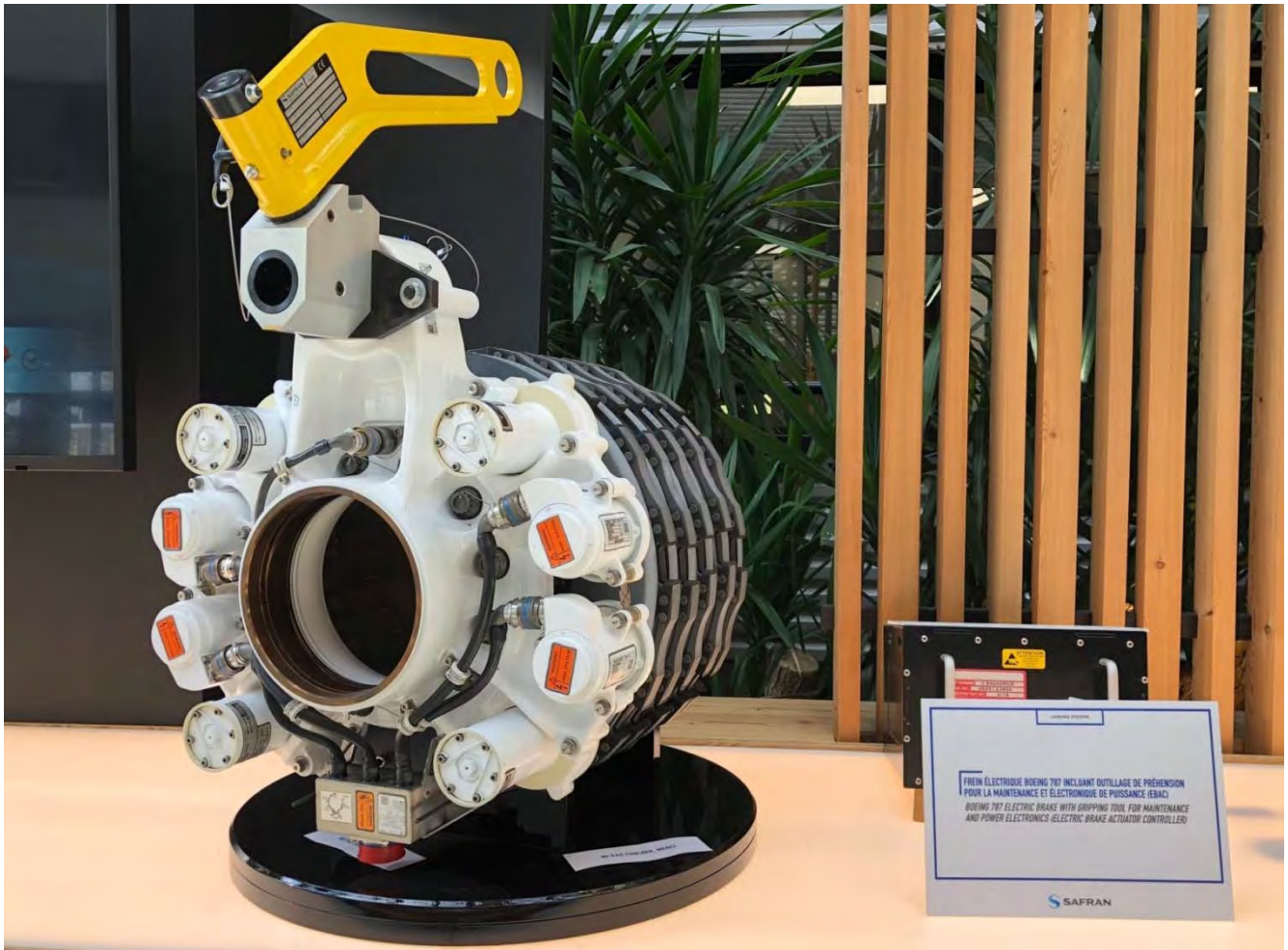
Frein carbone électrique Boeing 787 avec outillage de préhension pour la maintenance et électronique de puissance © Safran
