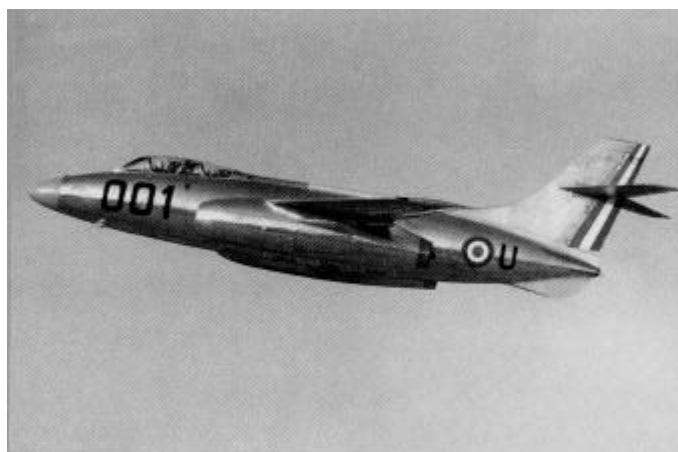
Le bombardier standard subsonique de l'armée de l'air des années 1950, le SNCASO 4050 « Vautour » décolle au poids maxi de 20 tonnes à grande vitesse, avec un train spécial monotrace Hispano-Suiza.
