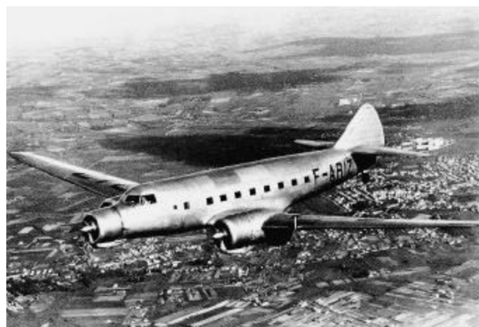
Trimoteur Dewoitine 342 d'Air France, 1938. Les moteurs sont devenus des « groupes moto-propulseurs » avec compresseurs, hélices à pas variable, carburateurs réchauffés, capotages aérodynamiques, les trains d'atterrissage des « systèmes hydrauliques » avec cadres, pompes, freins.
